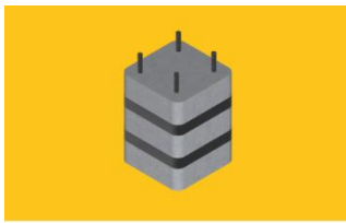
Confinamiento de columna
