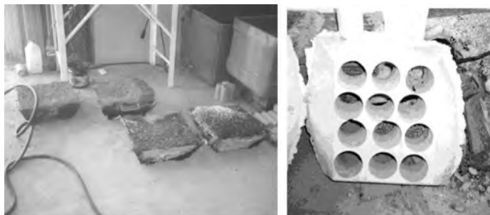
Foto. Artesas de ensayo de hormigón proyectado. Obtención de testigos
