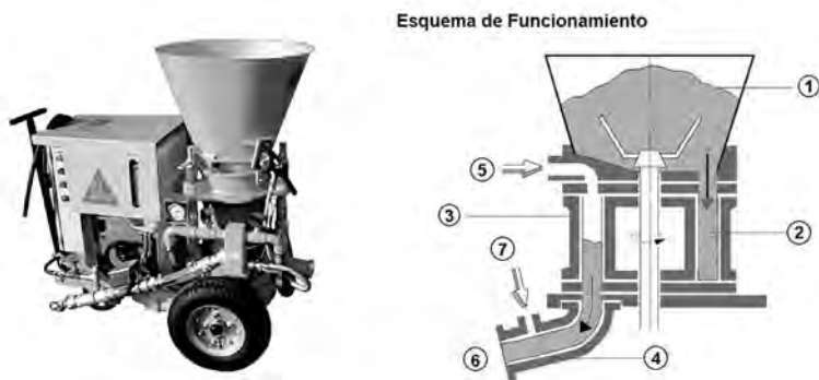
Figura 1.- Equipo Aliva 246. Esquema de funcionamiento
