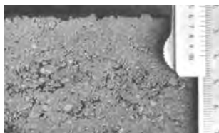
Arista irregular sin aditivo
