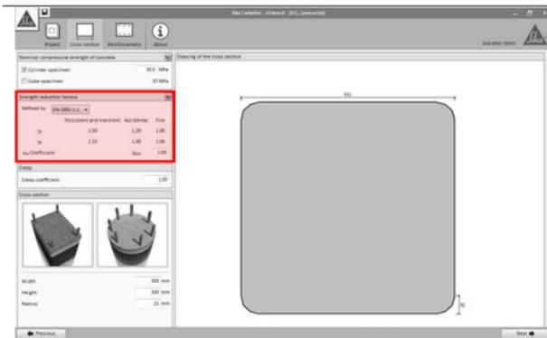
Los coeficientes de seguridad para el hormigón y el acero ( $\gamma_c$  y  $\gamma_s$ ) deben ser indicados por el usuario de acuerdo con el Eurocódigo 2 para determinar la resistencia de diseño del pilar. Además el usuario también puede modificar el coeficiente teniendo en cuenta los efectos a largo plazo sobre la resistencia a la compresión ( $\alpha_{cc}$  valor por defecto = 1)
