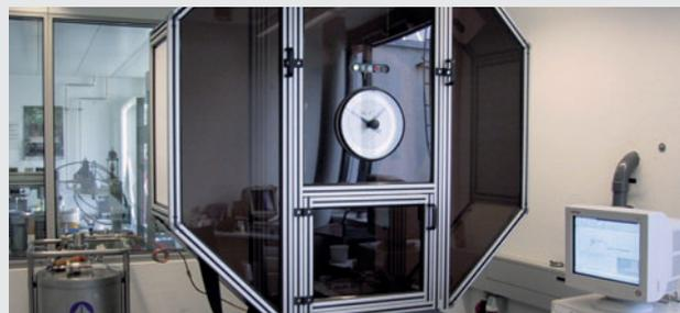
Maquina de ensayos con péndulo (ISO 11343) para velocidades de 1 m/seg hasta 5 m/seg a temperaturas entre -50°C hasta 80°C. Dado que el vidrio se deforma a una velocidad máx de 4m /seg esta es la carga máxima de ensayo para simular casos de explosiones con bomba.
