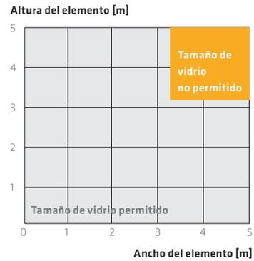
Fig. 3b: Bajo las mismas condiciones que en la fig. 3a los elementos de fachada pueden ser de mayor dimensión con la Sikasil® SG-500. Del mismo modo la altura de la junta para el mismo tamaño de elemento puede ser un 30% más pequeña, consiguiendo un ahorro del volumen total de la junta incluso del 60%.
