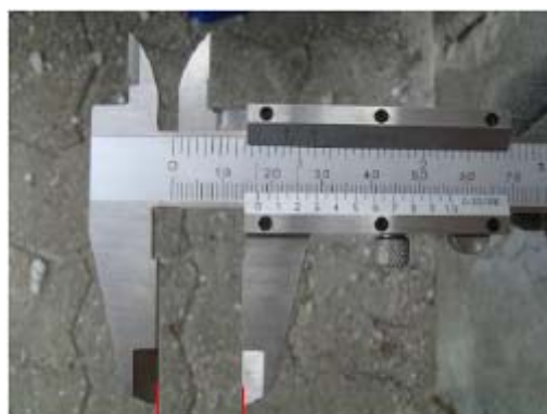
Medida del diámetro de la armadura
