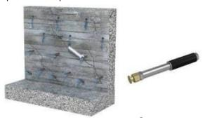
Una vez colocados todos los inyectores, empiece a mezclar el producto adecuado (Sika®Injection-304) para el objetivo deseado, consultando la ficha técnica del producto. La inyección de la resina se inicia desde el inyector más bajo y se continúa la inyección según se muestra en la imagen. Es recomendable realizar un primer tramo de inyección y después una reinyección, volviendo a empezar desde el primero y continuar en el resto de los tramos.
