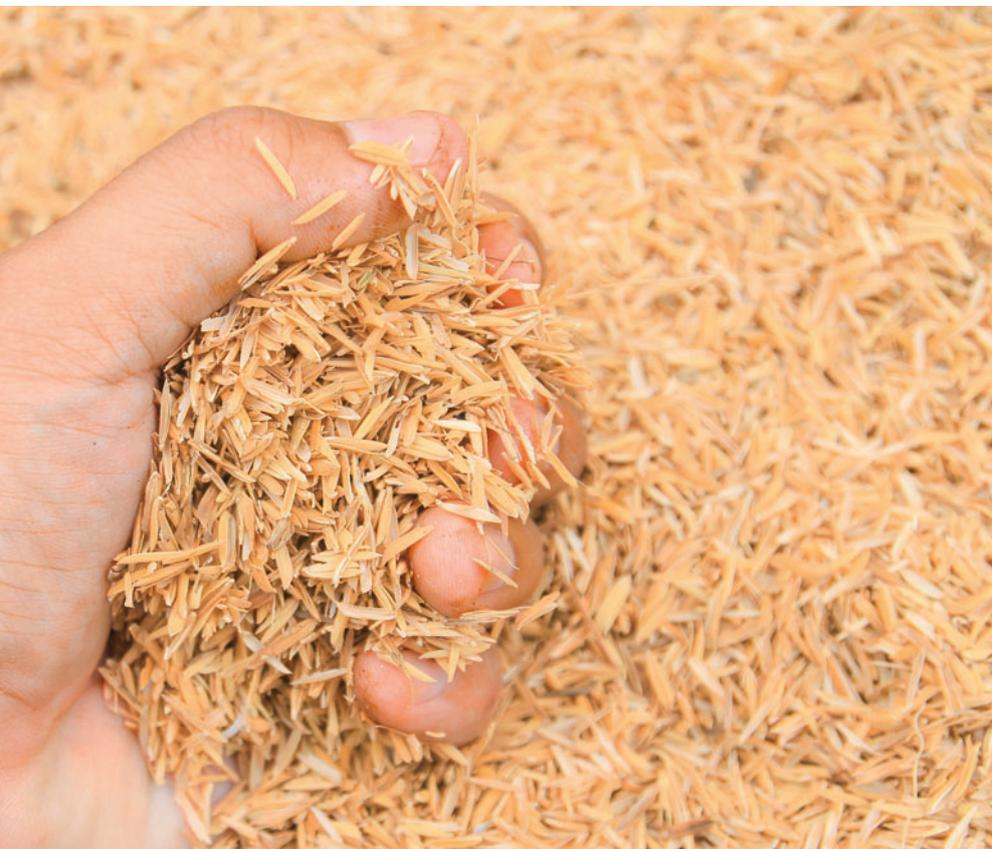
**CÁSCARAS DE ARROZ COMO SUSTITUTO AL CARBÓN EN CALDERAS DE VAPOR , JIANGSU SIKA TMS , MEZCLA CO. LTD PLANT NANJING, CHINA**
