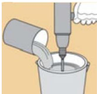
3. Mezclar la resina Sikadur®-Combiflex® Adhesivo, mezclando los dos componentes (A+B) durante al menos 3 minutos con una batidora eléctrica de bajas revoluciones (máx. 600 r.p.m.) hasta que el material tenga una consistencia y color homogénea.
