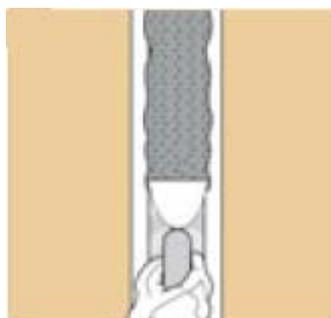
4. Aplicación del Sikadur®-Combiflex® Adhesivo. Extender con espátula el adhesivo a ambos lados de la junta, en un ancho de unos 6 cm y con un espesor de 3 mm aproximadamente.
