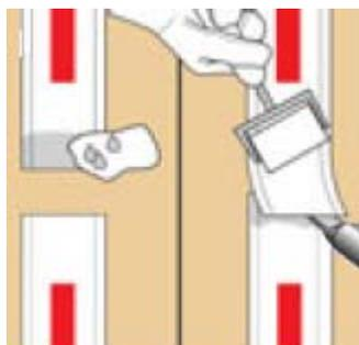
6. A continuación colocar la Banda Combiflex® sobre la junta, presionándola bien para que el adhesivo pase a través de los orificios practicados a lo largo de toda la banda en sus bordes.
