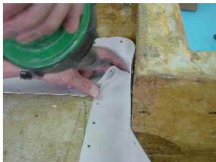
4. Calentar el interior de la arruga con el soldador de aire caliente.
