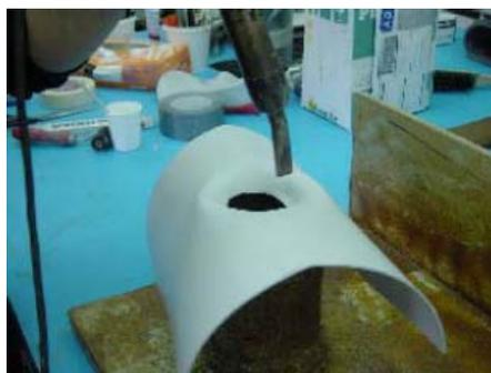
6. Calentar la Banda otra vez e ir moldeándola hasta obtener el diámetro adecuado con respecto a la tubería.
