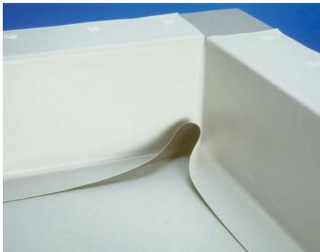
Aplique tiras de Sikaplan® y fíjelas de manera provisional sobre el peto. También los puede hacer soldando directamente la tira Sikaplan® sobre el perfil colaminado Sika®. Si la altura del peto es mayor de 50 cm, tendrá que fijar las tiras mecánicamente o con adhesivo sobre la superficie vertical.
