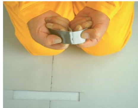
Una vez fría, la soldadura debe aguantar una prueba manual de pelado. Las membranas reforzadas pueden deslaminarse.
