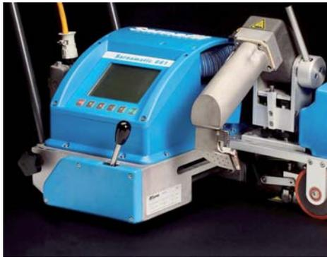
Utilice sólo la boquilla de 40 mm. Recomendamos montar una carga adicional de aprox. 5 kg en el soldador automático. Defina la carga adicional haciendo una prueba de soldado. Si es necesario utilice un aplicador de presión (barra).
