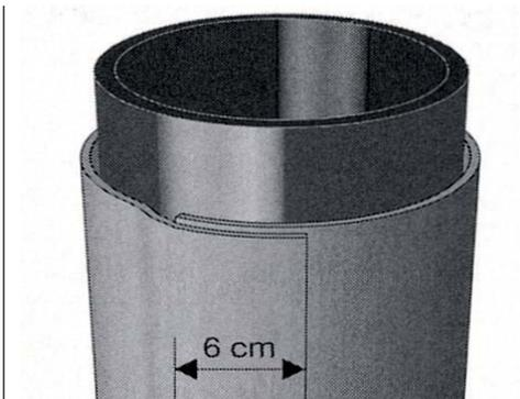
Mida y corte una pieza de membrana no reforzada. Hay que prever una longitud de solape sumándola a la longitud de la circunferencia (6 cm).
