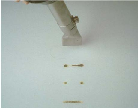
Un soldador de aire caliente que funcione perfectamente es la base de una soldura en el solape con garantías.
