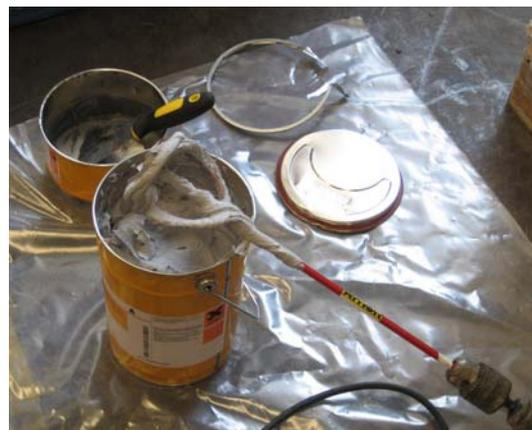
Fig. 6.4. Aspecto de la mezcla homogénea
