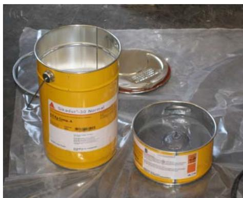
Fig. 6.1. Componente A-B del Sikadur®-30
