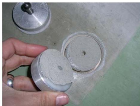
Fig. 5.13. Corte realizado con una taladradora con corona de diamante
