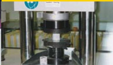
Resistencia a la compresión en testigos Prensa de rotura a Compresión **5**
