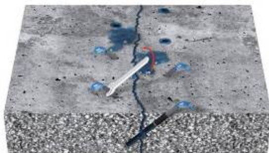
Figura 4.1-9 Detalle de ajuste del inyector en el soporte
