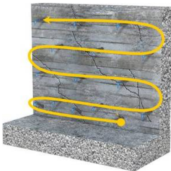
Figura 4.1-19 Inyección de la resina
