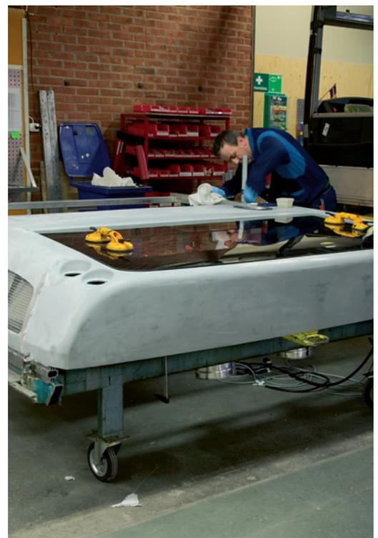
Ensamblaje del módulo posterior de aluminio
