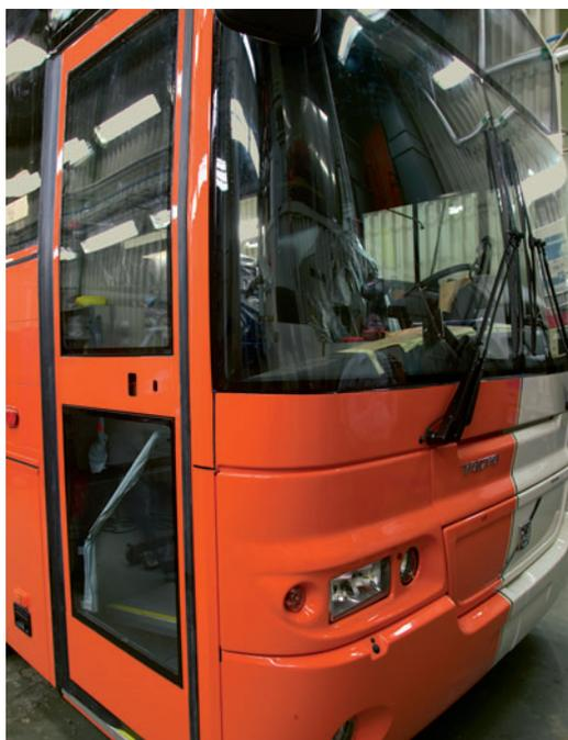
Instalación del cristal terminado, incluyendo el relleno
