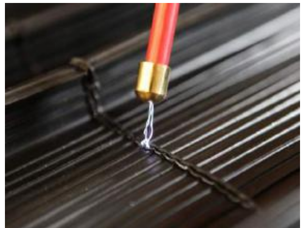
Figura 10. Control eléctrico de soldadura de juntas
