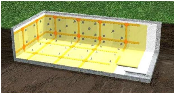
Figura 3. Disposición de compartimentos en una cimentación
