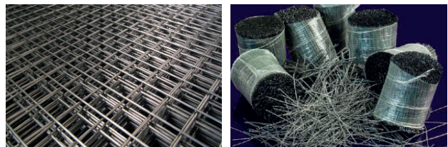
(a) Aspecto visual de los dos diferentes refuerzos: (a) mallazo de acero; (b) fibras de poliolefina Sikafiber T 48
