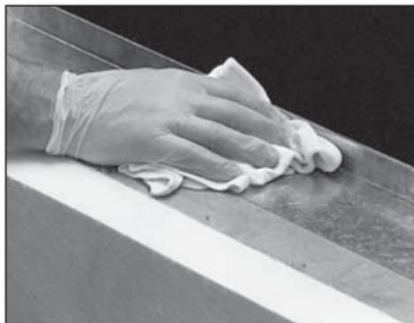
El material de soporte debe ser resistente a los disolventes, estar limpio, seco y sin grasa. Las láminas de metal deben desengrasarse con Disolvente T 660 antes de aplicar el adhesivo.
