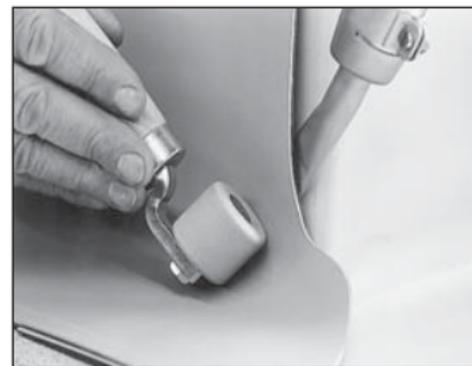
La boquilla de 20 mm de ancho se utiliza para las soldaduras situadas en esquinas y salientes (construcción detallada).
