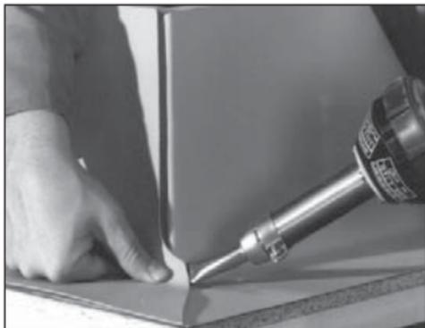
Para asegurar una construcción óptima detallada, la "lengüeta recortada" primero se debe estirar. Empezando por la "lengüeta recortada", soldar previamente por la junta vertical ...
