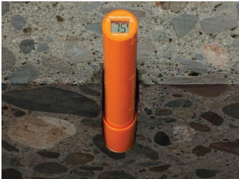
Humedad relativa (HR) ASTM F2170
