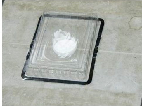
Cloruro de calcio ASTM F1869
