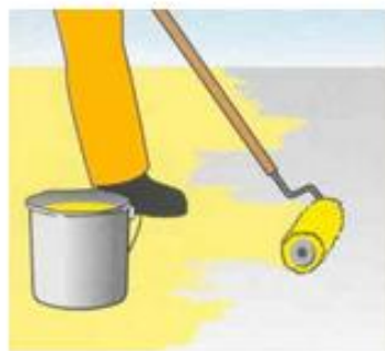
Aplicación pareja de capa de imprimación: Sikafloor®-150 / -151 con rodillo de pelo medio o brocha. P.e. Rodillo o brocha Polyplan
