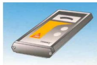
Medición de la humedad del soporte: Contenido de humedad < 4% en peso P.e. medidor Sika Tramex
