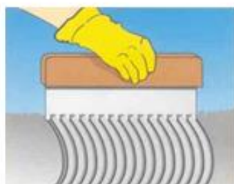
Reparto del Sikafloor®-3310 con llana dentada P.e. Lana dentada Polyplan 5/7 mm.
