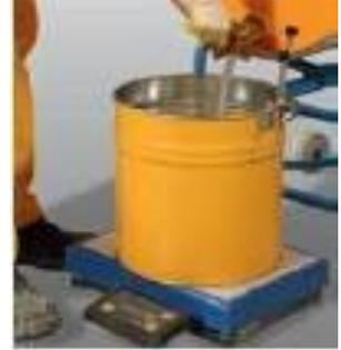
Los componentes A y B tienen que ser sopesados en su relación de mezcla especificada utilizando el aparato de medida Sika. Esto se hace sólo una vez. Una vez ajustado el medidor, éste puede utilizarse para medir las siguientes relaciones de mezcla.
