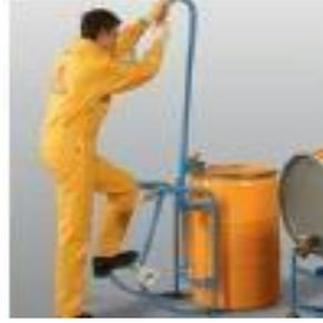
Usando carros basculantes, los bidones que contienen el componente A y B se pueden poner en una posición horizontal. Este equipo está especialmente diseñado para que estos bidones (aprox. 220 Kg ) puedan ser manejados fácilmente.
