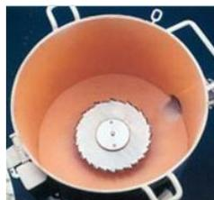
Para mezclar una mayor cantidad de producto de la gama Sikafloor® EpoCem, se recomienda utilizar la máquina UEZ ZZ 50 Dissolver-Mixer. Es adecuada para mezclar 50 litros o 90 kg sin grumos dentro del tiempo de mezclado.
