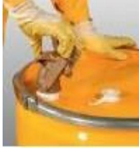
Después de retirar el mezclador de bidón, se vuelve a colocar la tapa original. En este momento, se puede colocar el dispensador o grifo del bidón. Para ello, enrolle previamente la rosca con cinta de teflón para evitar que existan fugas o pérdidas.
