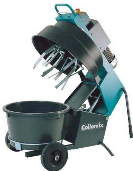
Esta máquina mezcladora (ColloMatic<sup>®</sup> XM) está diseñada para la mezcla correcta de cantidades más grandes de todos los tipos de morteros con cargas. En primer lugar, ponga el componente en polvo en el cubo de mezcla y, a continuación, añada la premezcla de componentes A + B o ligante líquido mientras se agita lenta y constantemente. Mezclar durante un mínimo de 3 minutos hasta que la mezcla es completamente homogénea.
