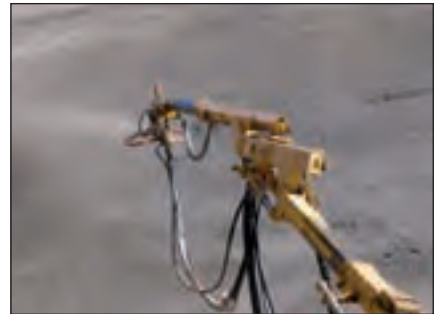
Foto 7.- Robot de gunitado Sika PM 500. Proyección de talud de emboquille
