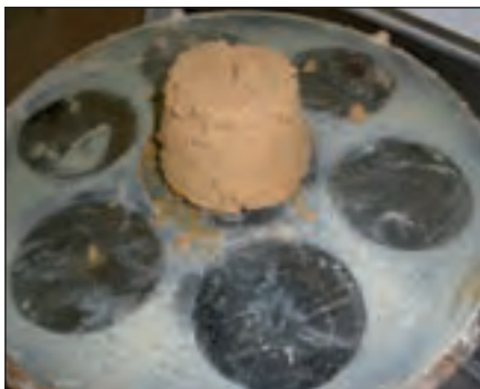
Foto 36.- Ensayo mesa de sacudidas sin/con Sika TBM Foam 103 y Sika TBM Soil
