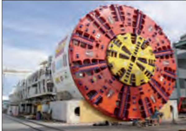
Foto 29.- Detalle de la cabeza de corte de un escudo
