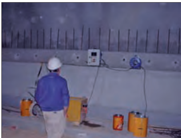
Foto 14.- Sistema Sika Adiabático de Inmersión en un ensayo en túnel
