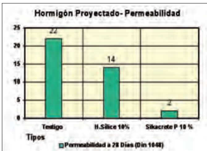
Figura 25.- Permeabilidad (mm) de distintas mezclas de hormigón
