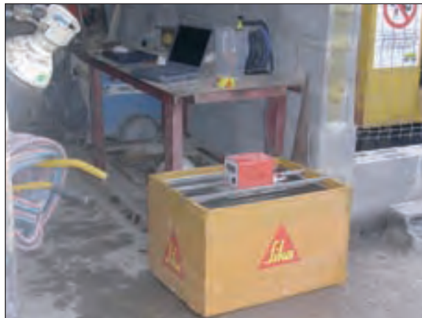
Foto 12.- Detalle del Sistema Sika Adiabático de Inmersión
