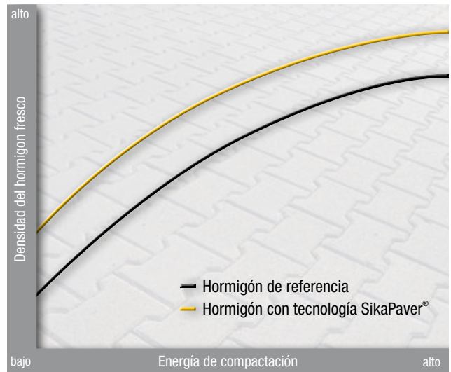
Facil compactacion hormigón semi-seco con la tecnología SikaPaver ®
