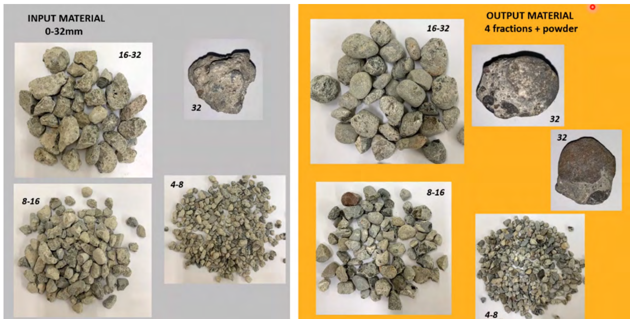
Comparativa de materiales de partida (áridos primarios) y materiales resultantes del proceso ReCO 2 er (áridos resultantes en el proceso).
