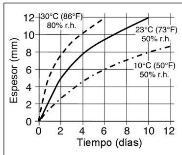
Diagrama 1: Velocidad de curado del Sikaflex®-265 DG-1
