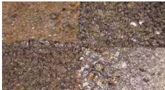
En sayos de exposición al fuego de hormigón que contiene distintos agregados. Descantillado de la superficie y sinterización, se puede comprobar el desarrollo de la temperatura en diversos grosores.
