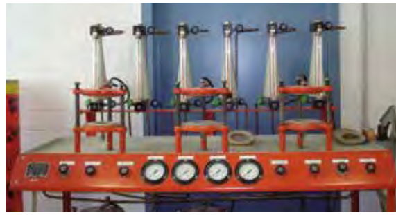
La absorción de agua del hormigón bajo presión mide la cantidad máxima de agua en mm durante un tiempo definido a una determinada presión. (24 horas con 5 bares según EN-12390-8)
