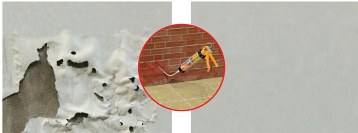
**Sikamur®-InjectoCream 100** es una sustancia repelente al agua, que se introduce en una serie de taladros realizados sobre mortero o mampostería mediante pistola. ¡No es necesaria bomba de inyección! Una única inyección en el mortero, dispersará al **Sikamur®-InjectoCream-100** en el muro y creará una barrera repelente al agua bloqueando la humedad ascendente en el futuro.
