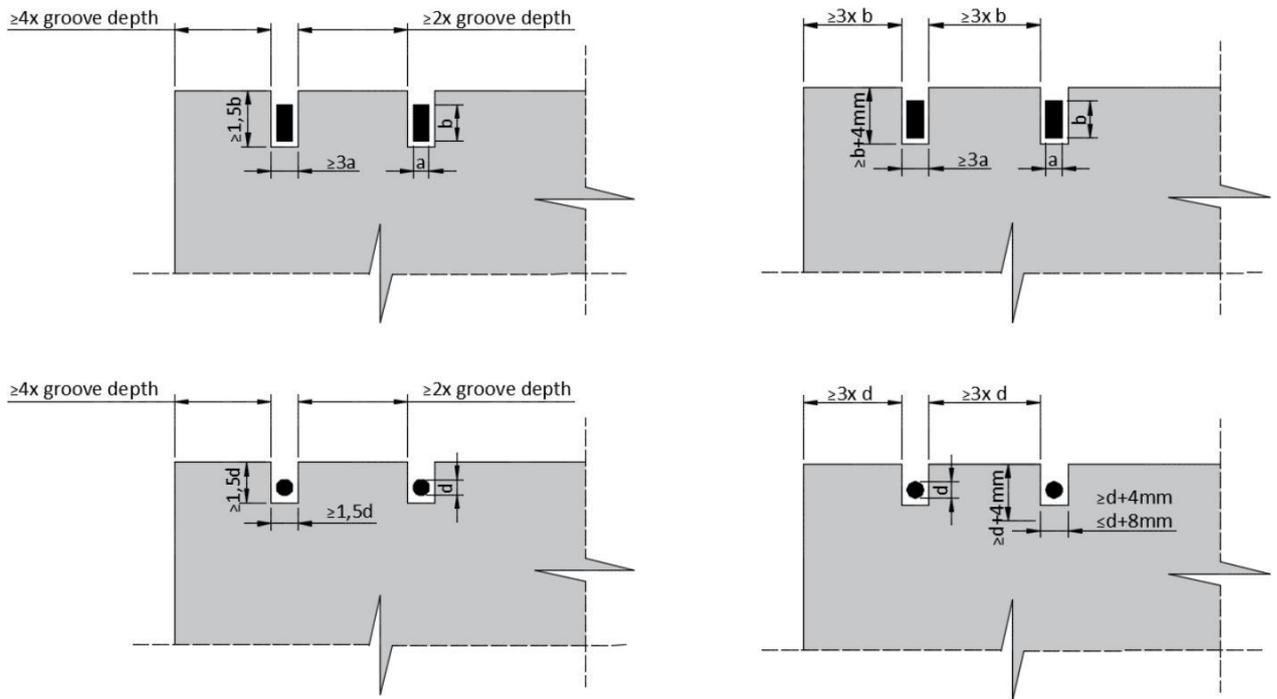
Aparte de estas normativas, existe más información sobre el dimensionamiento de las ranuras y que se detalla en el Método de aplicación Sika NSM. A continuación se ponen, como ejemplo, las dimensiones de las ranuras de algunos de los productos Sika que se utilizan para NSM:
