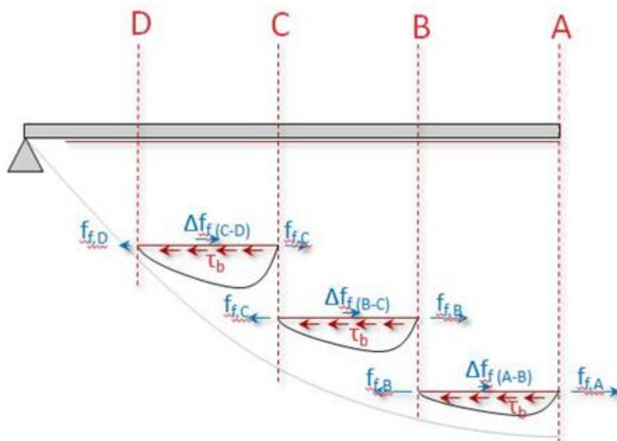
El esfuerzo cortante longitudinal creado sobre la capa de hormigón entre 2 secciones se puede describir como:
