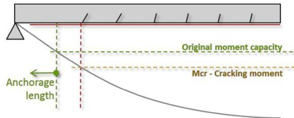
Para evitar un fallo de agrietamiento en el hormigón, la fuerza de anclaje final,  $T_{nsm, máx.}$  y su correspondiente longitud máxima de anclaje, se determinan de la siguiente manera:
