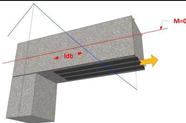
La longitud de desarrollo proporcionará la capacidad de anclaje suficiente para conseguir resistir la fuerza correspondiente a la tensión de diseño de la barra NSM ( $f_{fd}$ ), calculada como:
