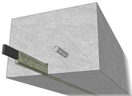
**Rotura del hormigón**
