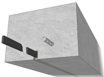
**Separación del recubrimiento del hormigón**
