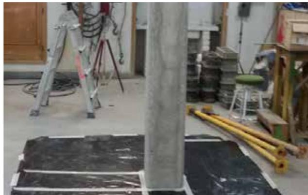
El objeto de la obra era evaluar la mejora conseguida con el refuerzo de fibra de carbono, en condiciones reales de aplicación. Para ello, los fustes construidos tenían dimensiones reales de pilares habituales en edificación, en lugar de tratarse de probetas a escala reducida.
