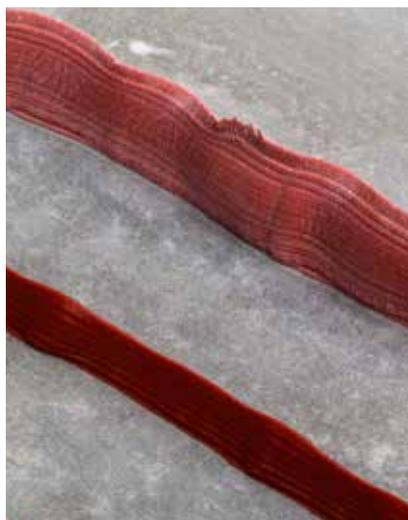
Producto en condiciones normales y expandidas después del contacto con agua.
