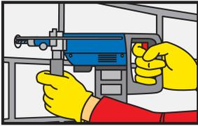
Perforación del agujero con taladro eléctrico al diámetro y profundidad requeridos. El diámetro del orificio de perforación debe estar de acuerdo con el tamaño del anclaje.
