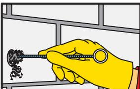
El orificio de perforación debe limpiarse a fondo con el cepillo de acero especial (cepillo al menos 2 veces). El diámetro del cepillo debe ser mayor que el diámetro del orificio de perforación.
