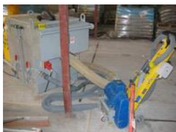
Escarificadora con aspiradora
