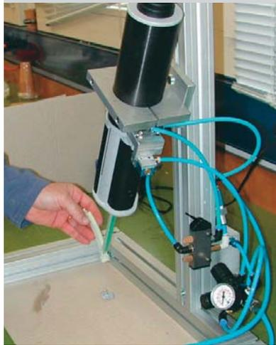
Instalación de una pistola neumática fija que simplifica el pegado de partes pequeñas.
