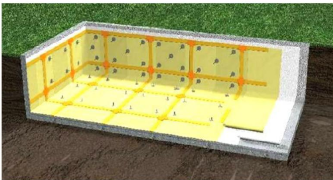
Figura 3. Disposición de compartimentos en una cimentación
