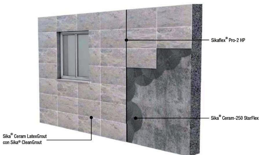
Finalmente las juntas sujetas a grandes movimientos y los perímetros se sellan estéticamente con una silicona o un sellador de poliuretano con color, de bajo módulo y gran elasticidad.
