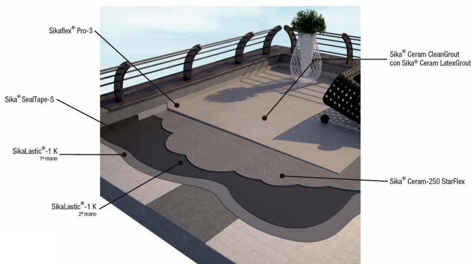
Completando este sistema existen lechadas flexibles de cemento impermeables con altas resistencias mecánicas y a la abrasión. Estas lechadas se mezclan con un látex especial que mejora el rendimiento y consigue de la lechada una clasificación tipo S1 según EN 12002. Un sellador de poliuretano de elasticidad permanente y alto rendimiento se utiliza para el sellado de juntas de movimiento y conexiones.
