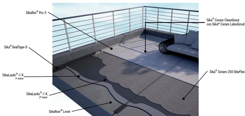
Las lechadas de cemento para uso en exteriores son también flexibles, con un módulo bajo de elasticidad, buenas resistencias mecánicas y a la abrasión. Estas propiedades se incrementan mediante la mezcla de la lechada con un látex especial. Se utiliza un sellador elástico de poliuretano con altas prestaciones y monocomponente, para sellar las juntas de movimiento o conexiones.
