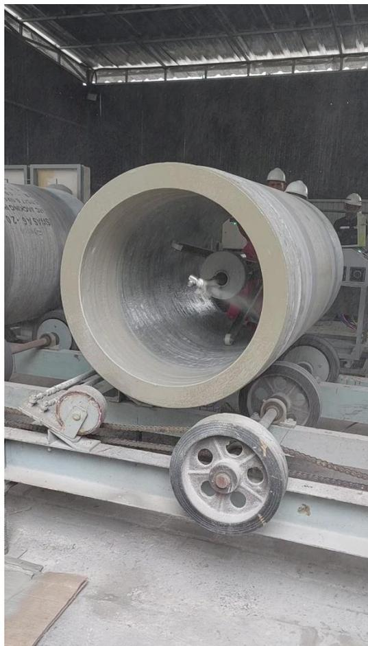
**Tubería en fase de revestimiento automático de Sikagard®-7000 CR**
