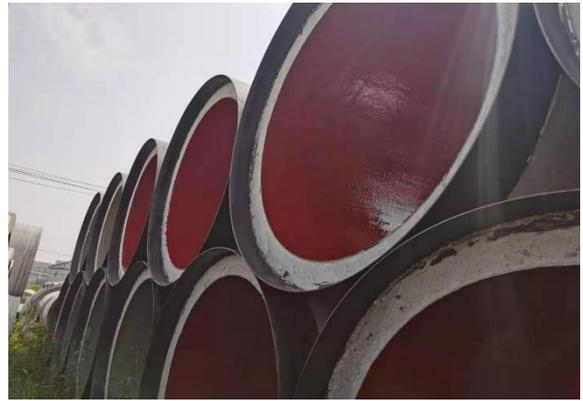
**Tubería de revestimiento por proyección manual de Sikagard®-7000 CR**
