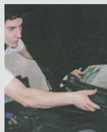
Coloque nuevamente las juntas y las molduras. Elimine los restos de adhesivo antes de que polimerice utilizando el **Sika® Remover-208**.
