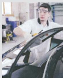
Coloque el nuevo parabrisas en su posición dentro del tiempo abierto del producto. Presione ligeramente por todo el perímetro del parabrisas para asegurar un buen contacto entre el cordón de adhesivo y el vidrio. Mantenga las puertas y ventanillas abiertas durante el proceso de instalación.
