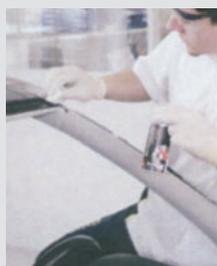
Preparación de la pestaña de la carrocería: limpie la superficie usando **Sika® Clean Glass**, repita esta operación hasta que esté completamente seca y limpia. A continuación, humedezca un papel limpio en **Sika® Activador** y aplíquelo sobre la pestaña
