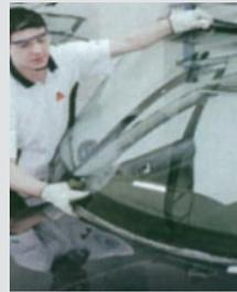
Presente la nueva luna y compruebe que ajusta perfectamente. Para asegurar un óptimo ajuste se recomienda que esta operación se realice antes de activar la superficie de pegado. Coloque los espaciadores necesarios y marque la posición correcta del parabrisas con cinta de enmascarar
