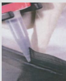
Aplique un cordón triangular de adhesivo en el borde de la pestaña de alojamiento del parabrisas en la carrocería, usando la cánula precortada que se suministra con el producto. Precaución: Observe las recomendaciones del fabricante y ajuste el espesor a la profundidad de la pestaña. Recorte la cánula si fuera necesario
