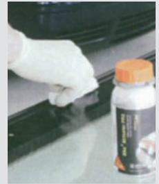
Preparación del parabrisas: límpielo usando **Sika® Clean Glass** hasta que el parabrisas esté completamente limpio y seco. A continuación, humedezca un papel o paño limpio que no deje restos en **Sika® Activador** y aplíquelo sobre la superficie del parabrisas donde se vaya a aplicar el adhesivo. Para la preparación del cordón antiguo de poliuretano debe aplicar el **Sika® Activador** de la misma manera que en el parabrisas.
