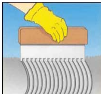
Extender Sikafloor 262 AS N con llana dentada. P.e. llana dentada polyplan 5/7 mm.
