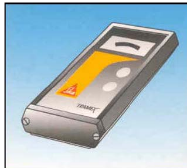
Medida de la humedad del soporte Contenido de humedad < 4% en peso Medidor de humedad Sika Tramex
