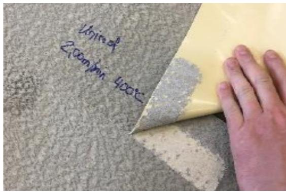
*Patrón de rotura ideal después de la unión térmica*
