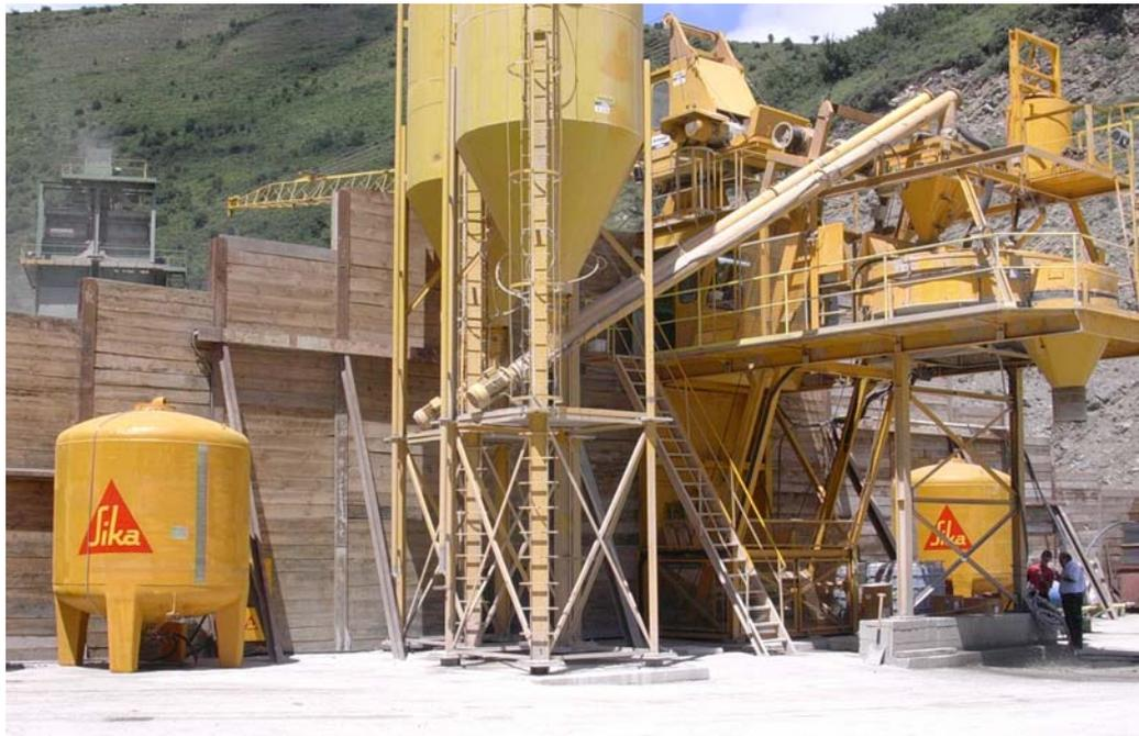
**Detalle de una planta de hormigón de obra**
