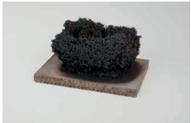
Envoltura resistente al fuego altamente intumescente antes (arriba) y después (abajo) de la exposición al calor
