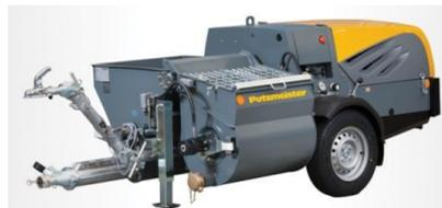
Bomba helicoidal de rotor, p. ej. Putzmeister P11 SP 16,2 KW. Con una presión máxima de 30 bar y un máximo de 52 m (Ø 50 mm) de manguera. No requiere mezclador externo
