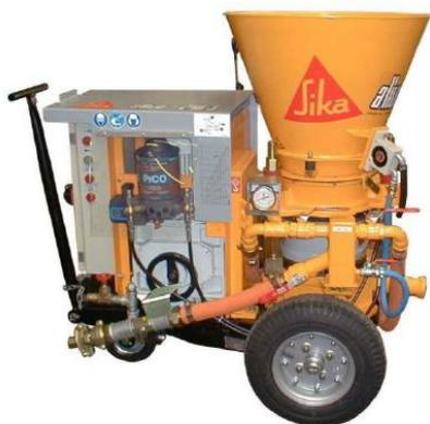
Máquina de proyección en seco rotativa de hormigón, p.ej. Aliva® -246 400 V/440 V/220 V. Con una capacidad máxima de la tolva de 45 litros y 150 m de distancia máxima de transporte horizontal y 60 m de distancia de transporte vertical. Cuando se requiera una distancia de transporte superior a 80 m, se utilizarán tubos de acero. Recomendado para reparaciones a larga distancia o para reparaciones en las que no se pueden seguir las recomendaciones del equipo de limpieza.
