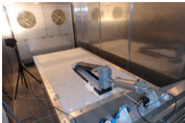
Prueba de carga horizontal de un bastidor SSM1 en una cámara climática
