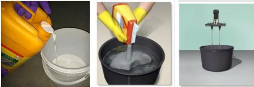
Homogeneizar el componente A antes de su uso. Verter aproximadamente la mitad del componente A en el recipiente de mezclado y añadir la parte B lentamente mientras se mezcla. Añadir la parte restante del componente A y continuar mezclando hasta conseguir una mezcla homogénea.
