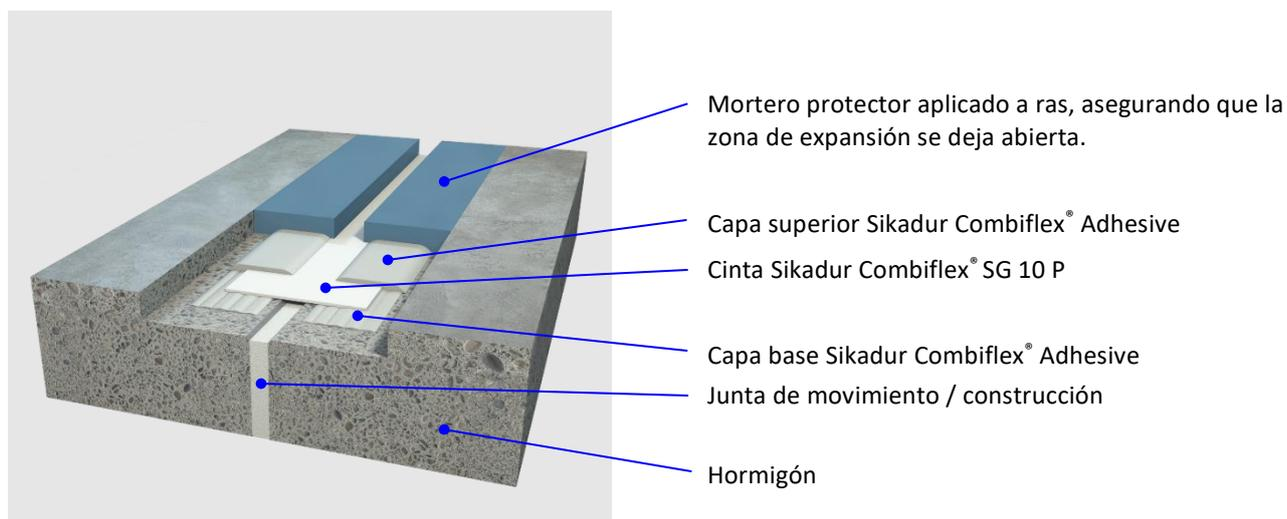
El sistema **Sikadur-Combiflex® SG** es idóneo para el sellado elástico y estanco de juntas de tamaño o forma irregular, grietas, juntas con grandes movimientos.
