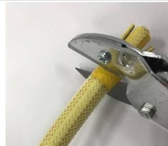
Corte las mangueras de PVC de los extremos, verde y transparente, a las longitudes deseadas. Aplique el super pegamento en los tubos de conexión para asegurar una buena unión.
