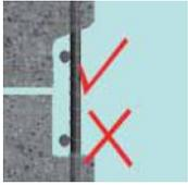
La superficie del sustrato de hormigón debe tener una rugosidad superficial de 2 mm, para así mejorar la adherencia de acuerdo con EN 1766: cláusula 7.2 para superficies horizontales.
