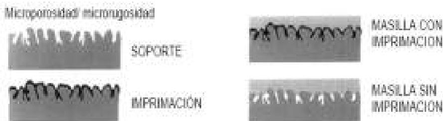
La elección de una u otra imprimación se hará en función del material donde vaya a ir colocada. Todos los soportes requieren una imprimación previa cuya elección se hará según se indica en la siguiente tabla.
