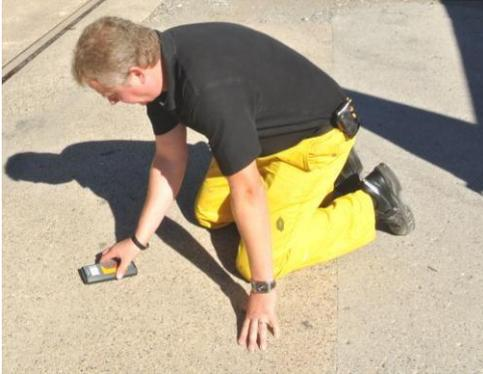
Medición de la humedad del soporte: El contenido de humedad debe ser  $<4\%$  en peso. Los dispositivos adecuados, para llevar a cabo la medición en obra, son, por ejemplo, el medidor de humedad Sika Tramex o el Método de carburo de calcio que proporciona lecturas más precisas.
