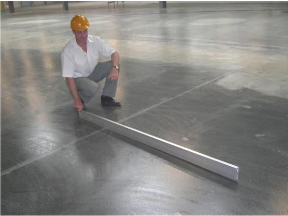
La medición de la uniformidad del pavimento de hormigón se basa en la norma alemana DIN 18202 "Tolerancias en la construcción de edificios"; Página No. 9; "Límites para la desviación de la uniformidad" Cuadro No. 3, línea 3.
