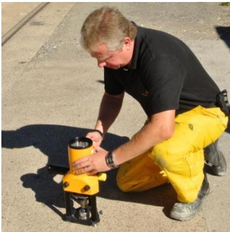
La resistencia a arrancamiento debe ser  $> 1,5 \text{ N/mm}^2$ .
