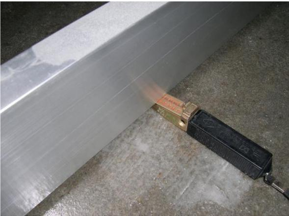
Para la medición se necesita una regla de aluminio o de acero y una cuña de medición.
