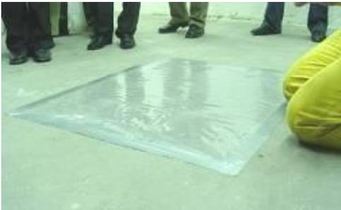
El método de lámina de plástico para la medición de humedad es una manera rápida, fácil, no destructiva, y de bajo costo para calcular el exceso de humedad. Sin embargo, no proporciona ningún resultado cuantitativo. En caso de duda el Método de carburo de calcio tiene que utilizarse.
