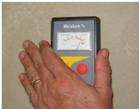
Medidor de humedad Tramex.
