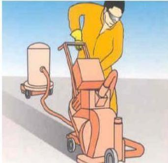
Preparación del soporte con granalladoras u otro tipo de métodos mecánicos
