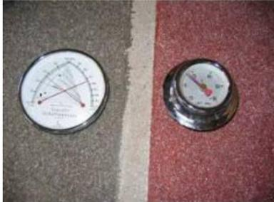
Contenido de humedad < 4% si se aplica una imprimación con Sikafloor®- 150 / -151
