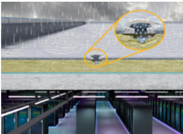
La membrana impermeabilizante de la cubierta dañada mecánicamente entra en contacto con el agua.
