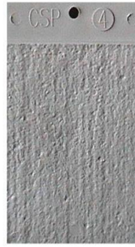
CSP-4: Ligero/medio granallado Escarificado ligero/ abujardado
