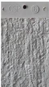
CSP-6: Escarificado medio
