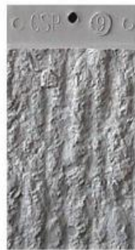
CSP-9: Gran escarificado
